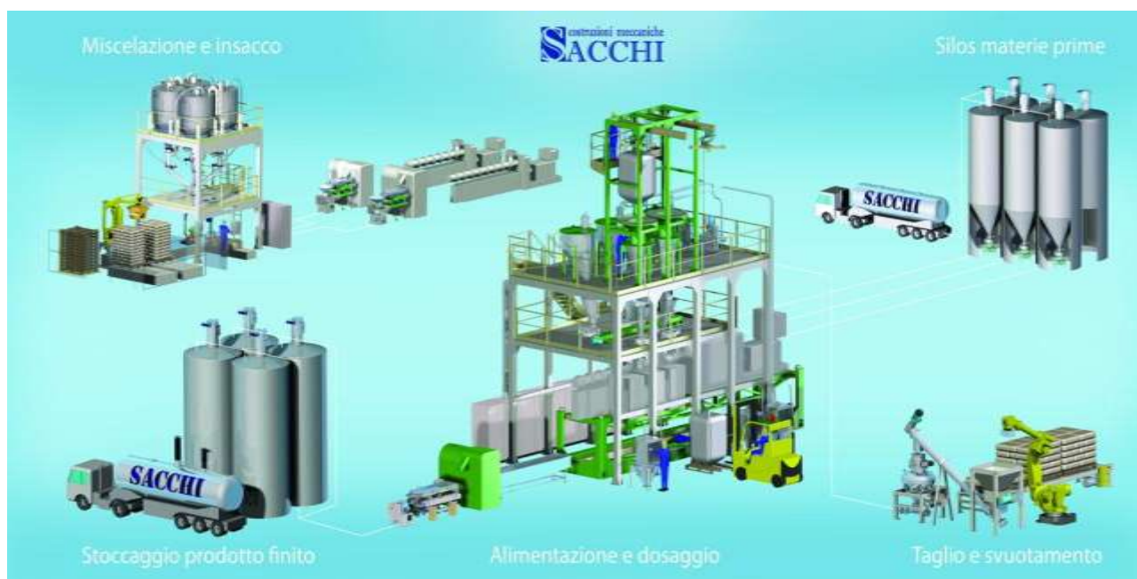
Impianto completo per la produzione di granuli plastici
